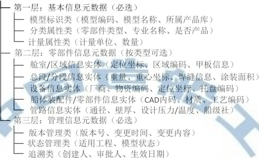
图1 船舶产品数据模型元数据架构
